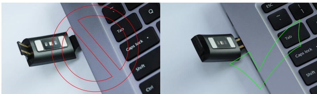
\* Tenga en cuenta que los dos contactos de carga no pueden hacer contacto entre sí por medio de un material conductor ya que puede causar la quema del circuito.
